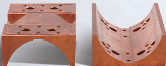
Plaques de contact: Utilisées dans les fours d'alliage de fer, elles sont équipées de canaux de refroidissement. Fabriquées en CuZn (85% - 15%) ou en cuivre pur à haute conductivité
